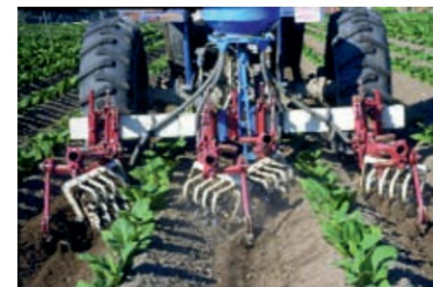
Figura 1: Abonadora, echando abonos en cobertera, detrás se va haciendo una labor, y enterrando dicho abono. El abono cae localizado y al alcance de las raíces.
